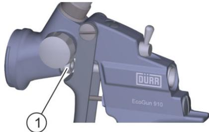
Fig. 21: Montar a caixa de empanque da agulha
